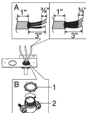
Prepare el cable del conducto (sin aislamiento) como se muestra en la figura A.
