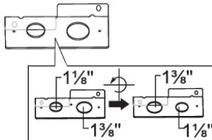
Retire la placa de conexión del conducto retirando dos tornillos y girándola, como se muestra abajo. Se debe usar el orificio del conducto ( $1\frac{1}{8}$ "). Vuelva a apretar ambos tornillos.
