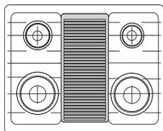
La plancha de hierro fundido reversible solo se puede usar sobre los quemadores centrales de la estufa. Antes de encender el quemador, asegúrese de que la rejilla esté colocada correctamente.
