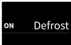
La función Defrost mode se utiliza para descongelar controlada y automáticamente los alimentos congelados (tortas, pasteles, pan y bollos, y frutas ultracongeladas). La temperatura está preestablecida y no se puede modificar. Cuando llegue a la mitad del proceso de descongelación, dé la vuelta, mueva o separe los alimentos.
