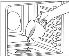
Vierta un máximo de 1 taza de agua en la base del interior del horno.
