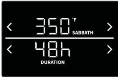
Hornear durante el modo **Sabbath Mode**. Configure la temperatura y la duración del horneado. En la parte superior de la pantalla, verá la temperatura predeterminada de 350 °F (177 °C). Puede ajustar la temperatura entre 175 °F (79 °C) y el máximo de 425 °F (218 °C). En la parte inferior de la pantalla verá el tiempo predeterminado de 48 horas. Puede configurarlo en un rango de entre 1 y 74 horas.
