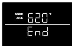
Cuando la temperatura descienda por debajo de los 400 °F, los aparatos se desbloquearán y pasarán al modo de espera. Una vez que el interior del horno se haya enfriado por completo, límpielo con agua jabonosa y un paño suave para eliminar cualquier residuo (por ejemplo, cenizas).
