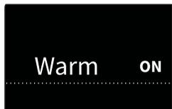
Este modo le permite mantener caliente la comidas ya cocinada. La temperatura para este programa se puede ajustar entre 140 °F (60 °C) y 210 °F (99 °C), y puede establecer Cooking Time entre 0 minutos a 3 horas. Recomendamos utilizar un Cooking Time de 30 minutos.
