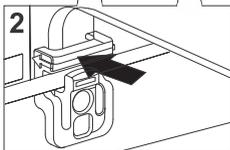
2 Empuje simultáneamente los dos espaciadores de cada lado hacia atrás en la dirección que indica la flecha.
