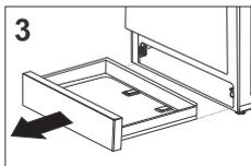
3 Retire completamente el cajón.
