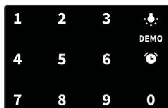
El teclado se puede utilizar para ajustar la temperatura o el tiempo. Para ajustar la temperatura simplemente introduzca el valor deseado. Para
